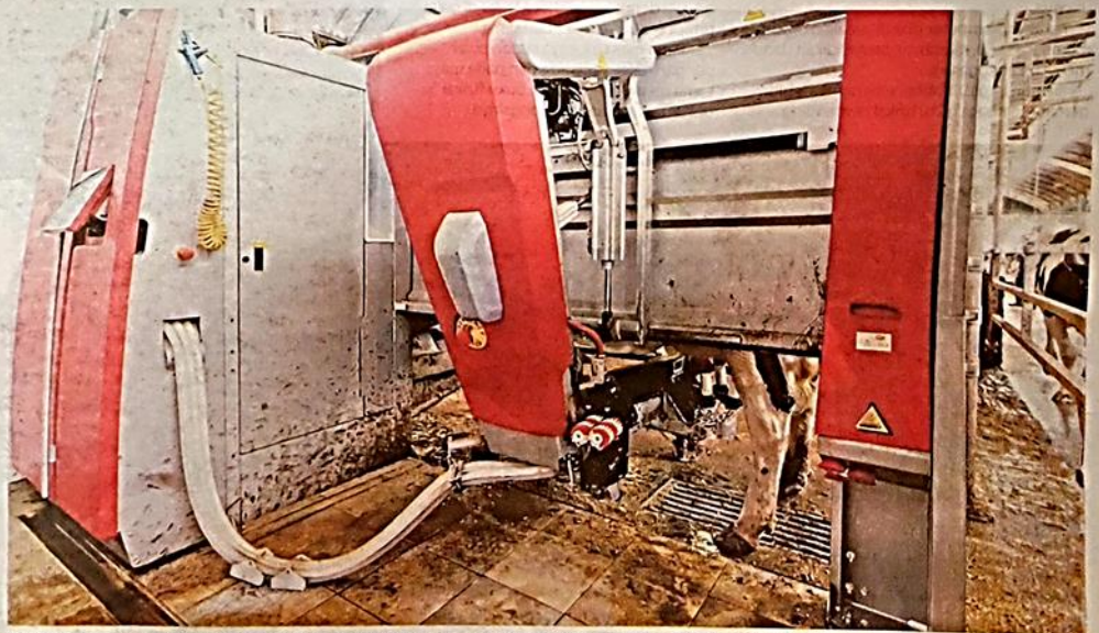
LELY Astronaut merupakan robot perahan susu yang mampu melakukan kerja secara automatik apabila lembu betina bersedia.
